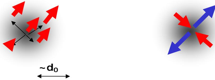
**Figura 11** - Esempio di calcolo dello strain rate. A sinistra il punto centrale è uniformemente circondato da almeno altri quattro punti di velocità nota, entro una circonferenza di raggio pari alla distanza di decorrelazione delle velocità. A destra, le cinque velocità sono mappate in strain rate, che viene associato a un'area centrata nel punto centrale della figura a sinistra, e di estensione uguale a una circonferenza di raggio pari alla distanza di decorrelazione.
